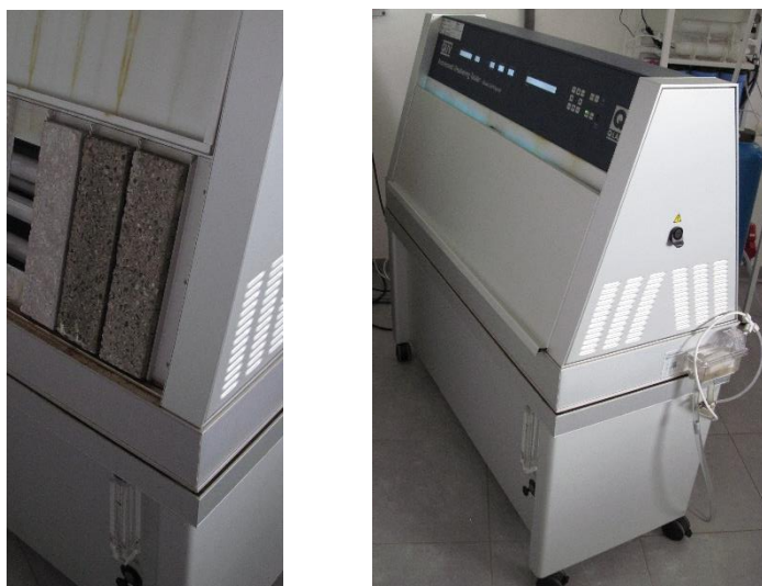
Obr. 2 Stárnutí zkušebních vzorků v UV-komáře
